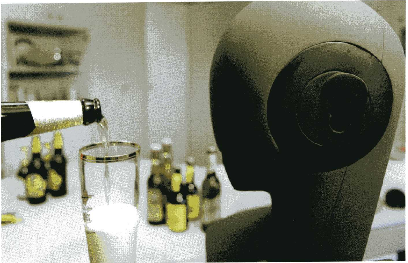
Gluckern für den Kunstkopf: Im Labor wird gemessen, wie verschieden geformte Bierflaschen beim Eingießen klingen
