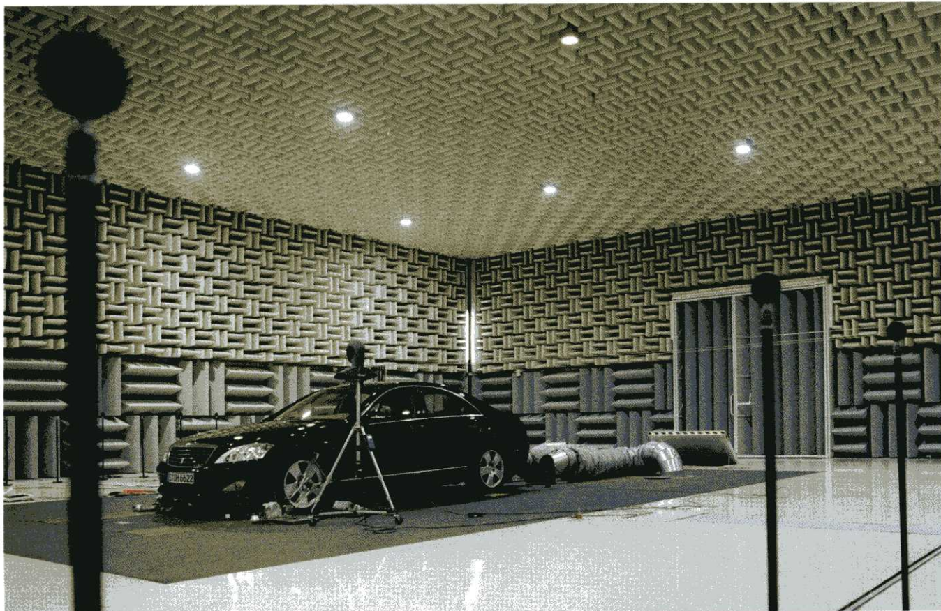
Wertanmutung: Im Messraum für Außengeräusche bei DaimlerChrysler wird der Klang neuer Autos bis ins Detail analysiert
